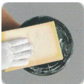
1. Očistěte povrch přísavky.
